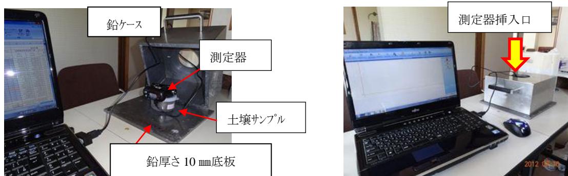
Fig-3 バックグラウンド遮蔽機器による測定システム全景
